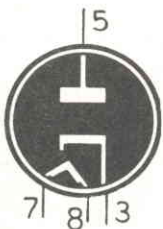
25W4 DIODO RADDRIZZ. (zoccolo octal)
